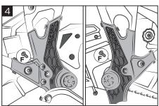
Attach the X-Grip using the screws (F). Fissare gli X-Grip tramite vite (F).
